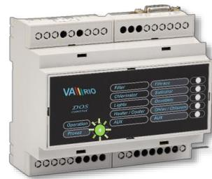
Bliká-li zelená LED dioda v levé spodní části, znamená to, že je modul DIN pod napětím. Rytmus blikání se mění (**je rychlejší**) v případě komunikaci DIN modulu s dávkovací stanicí.
